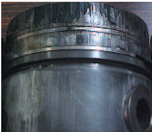
Fig. 2.7.9 Gripaje iniciado en la zona de fuego
