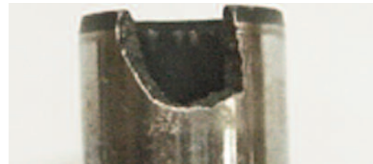
Fig. 12.4.3 – Detalle de la rotura del diámetro interno
