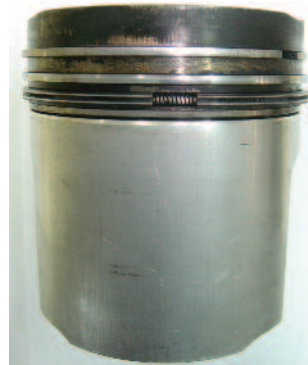
Pistón con características normales de funcionamiento
