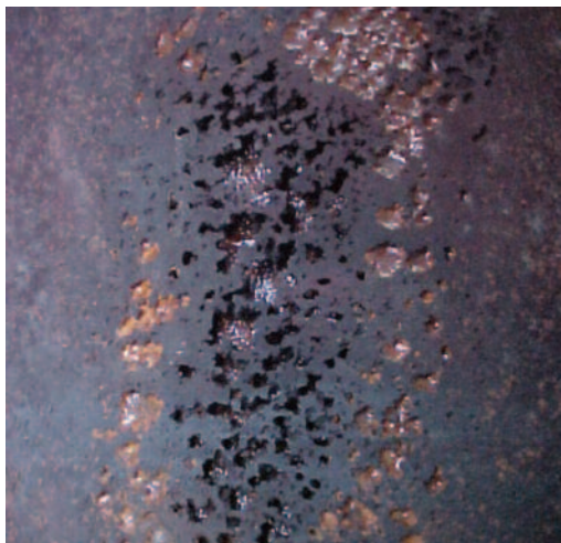
Fig. 6.1.2 Cavitación y escamas
