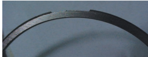
Fig. 3.4.2 Cara de contacto astillada
