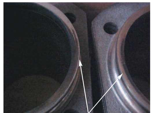
Fig. 4.1.5 Apoyo irregular de la camisa con la tapa de cilindro
