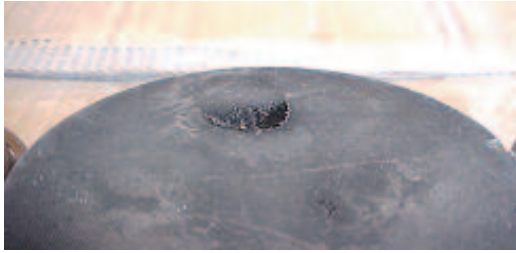
Fig. 2.7.6 Destrucción parcial de la cabeza debido a la inyección
