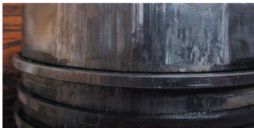
Fig. 2.7.4 Gripaje iniciado en la zona de fuego
