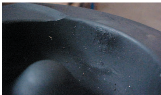
Fig. 2.6.1 Pulverización ocurrida parcialmente fuera de la cámara de combustión
