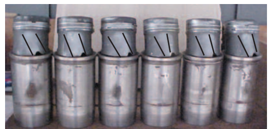
Fig. 1.3.4 Marcación inclinada en la región de la falda del pistón
