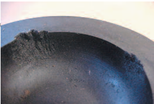
Fig. 2.7.1 Destrucción parcial de la cámara de combustión
