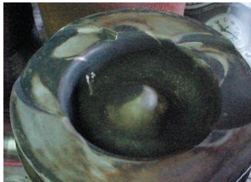
Fig. 2.6.4 Pulverización irregular del inyector
