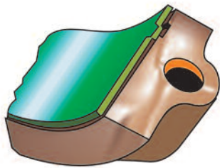
Fig. 9.4 Resaltos de centrado no coincidentes
