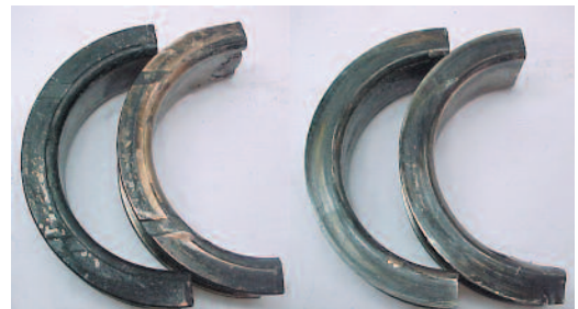
Fig. 8.1.3 Brida delantera del cojinete sin desgaste y trasera con desgaste
