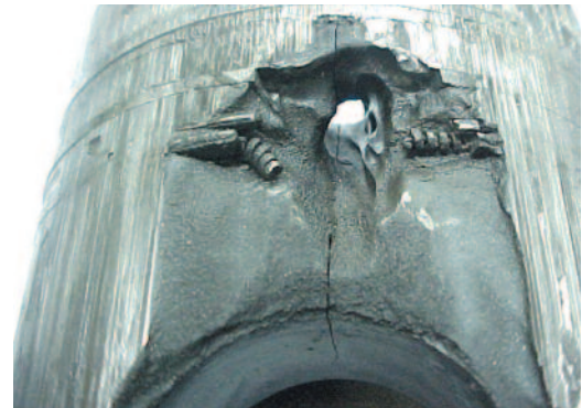
Fig. 2.7.11 Destrucción de la cabeza y de la región del cubo debido al inyector con funcionamiento irregular
