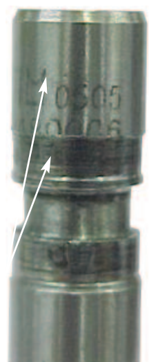
Fig. 11.4.4 Desgaste en la región del canal de traba provocado por irregularidad en la traba
