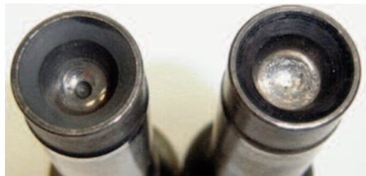
Fig. 12.4.5 – Muesca con apoyo irregular de la varilla de empuje
