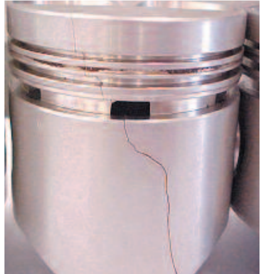
Fig. 2.14.3 Pieza agrietada durante el embielado
