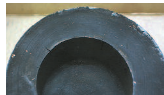
Fig. 2.13.6 Grietas existentes en el borde de la cámara de combustión
