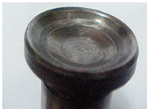
12.1.2 – Desgaste excesivo del platillo levanta válvulas
