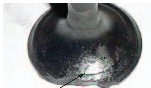
Fig. 11.5.1 Parte de la cabeza quebrada
