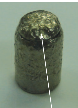
Fig. 11.4.1 Rotura en la región del canal de traba
