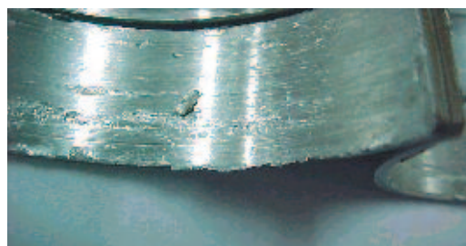
Fig. 7.6.2 Esgurrimiento de la aleación
