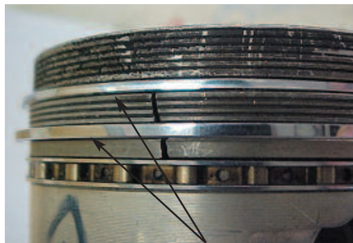
Fig. 2.15.2 Pared entre ranuras fracturada en pistón aplicado en motor línea Liviana
