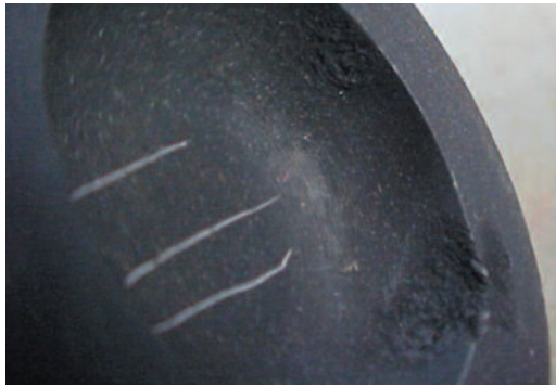
Fig. 2.7.2 Destrucción parcial de la cámara de combustión
