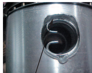
Fig. 1.1.3 Daños provocados por la traba
