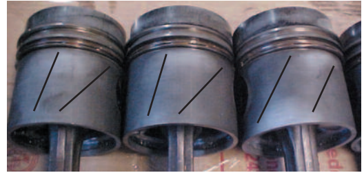
Fig. 1.3.1 Marcación inclinada en la región de la falda del pistón
