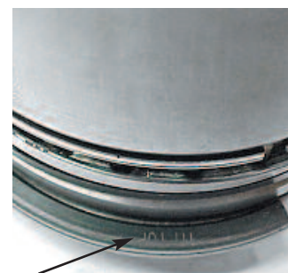
Fig. 3.1.1 Marca del aro montado hacia el lado de abajo
