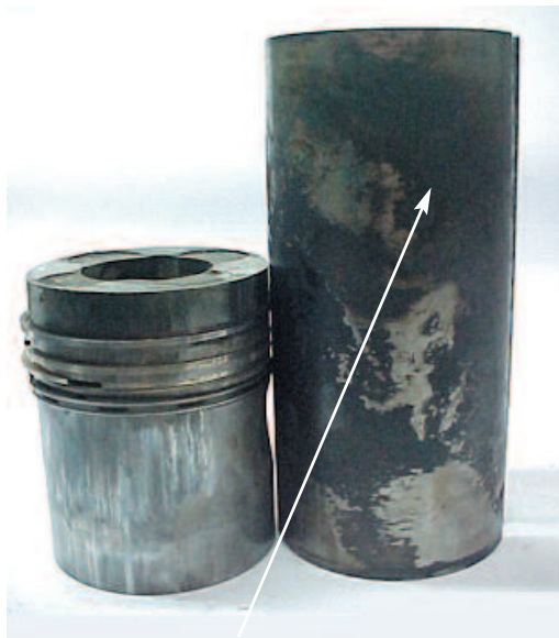
Fig. 5.2.1 Marcas oscuras en el lado externo de la camisa, identificando falta de interferencia con el alojamiento
