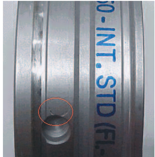
Fig. 8.13.1 Marca de la espiga en la parte externa del cojinete
