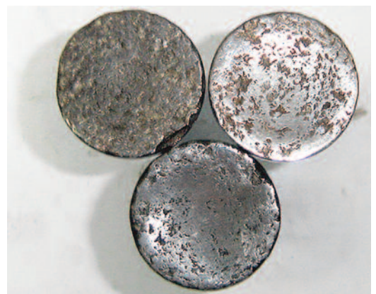
Fig. 12.3.1 – Desgaste y deformación de la base
