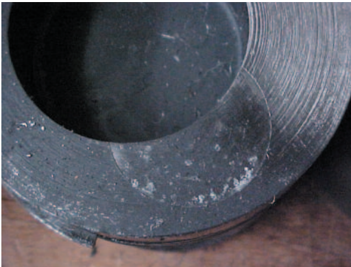
Fig. 2.8.1 Marca de válvula en la cabeza labrada del pistón
