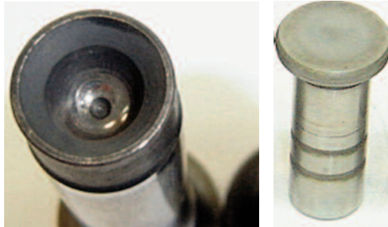
Botador mecánico con desgaste normal de funcionamiento
