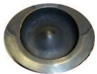
Fig. 2.13.4 Labrado del rebaje de válvulas
