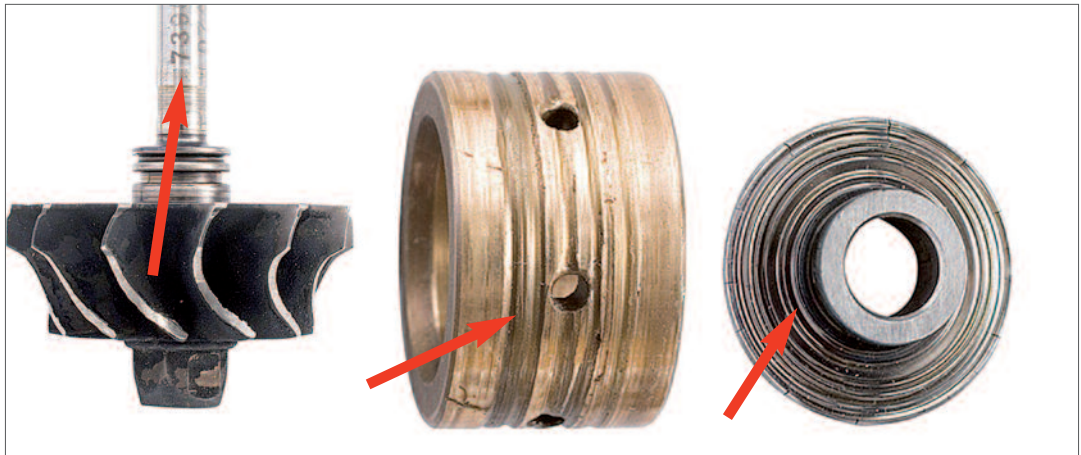
Fig. 13.1.1.5 - Eje del rotor, bancada radial y espaciador
