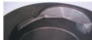
Fig. 2.13.5 Labrado del rebaje de válvulas
