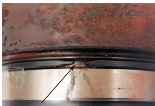
Fig. 5.2.4 Aro O'ring cortado durante la instalación de la camisa en el bloque
