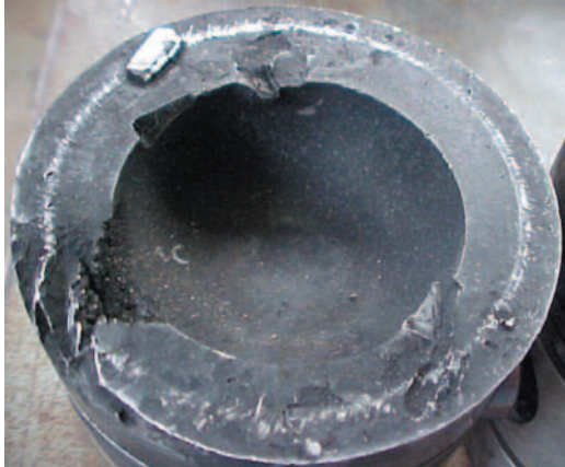
Fig. 2.7.7 Destrucción parcial de la cabeza debido a la inyección
