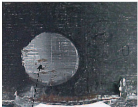
Fig. 10.2.6 Marca externa provocada por el cuerpo extraño
