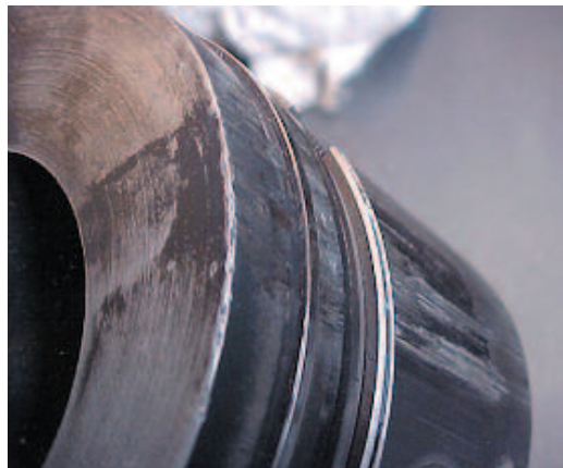
Fig. 2.6.6 Pulverización irregular del inyector
