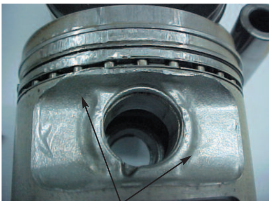
Fig. 1.1.1 Daños provocados por la traba
