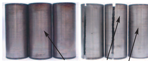
Fig. 5.2 Camisa con marcas del labrado del bloque
