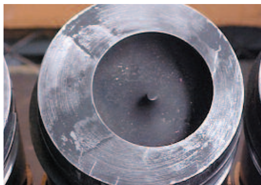
Fig. 2.6.5 Pulverización irregular del inyector
