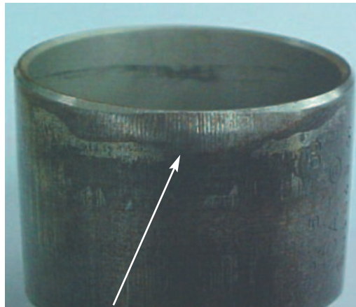
Fig. 10.3.2 Marca del encasquillado inclinado
