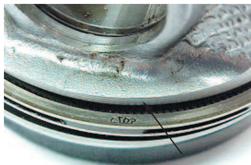
Fig. 3.1 Marca del aro montado hacia el lado de abajo
