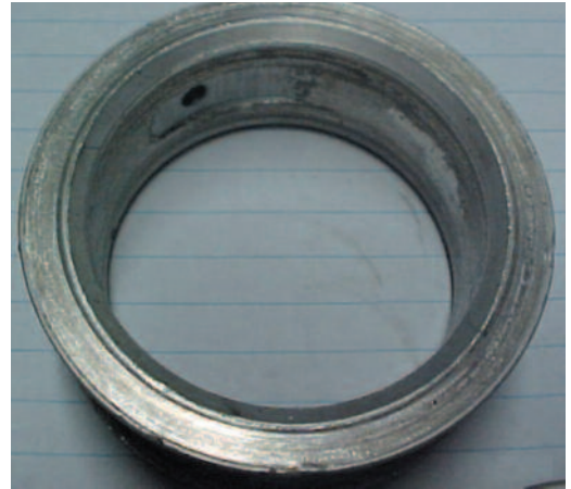
Fig. 8.1.2 Brida totalmente desgastada
