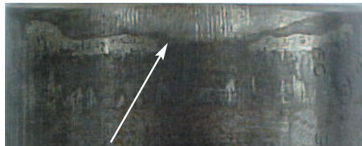
Fig. 10.3.3 Marca del encasquillado inclinado
