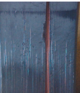
Fig. 8.2.5 Foto ampliada del canal abierto por el cuerpo sólido extraño en el cojinete
