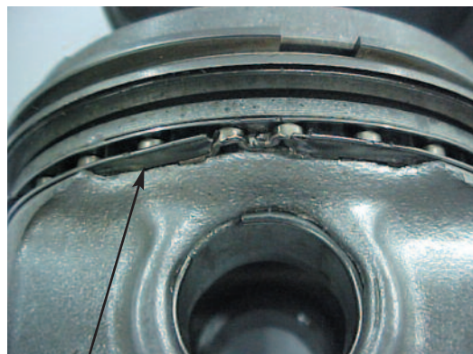
Fig. 1.1.2 Daños provocados por la traba
