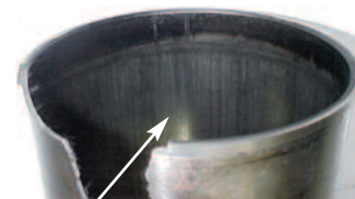
Fig. 6.3 Desgaste y raya provocados por partículas sólidas admitidas para dentro del cilindro
