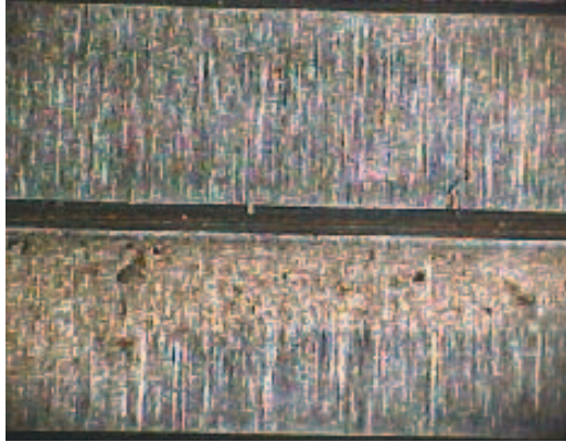
Fig. 3.5.1 Aros con rayas en la cara de contacto
