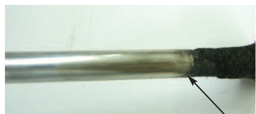
Fig. 11.1.4 Gripaje en función de residuos fijados en el vástago
