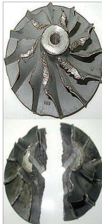
Fig. 13.2.2 – Rueda compresora con marcas de impurezas
