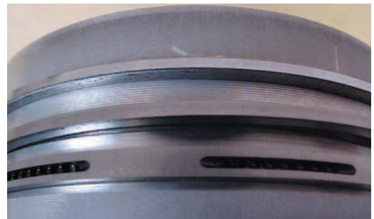
Fig. 3.5.6 Aro de la tercera ranura desgastado
