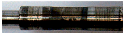
Fig. 13.1.2.2 – Rayas en el eje del rotor
