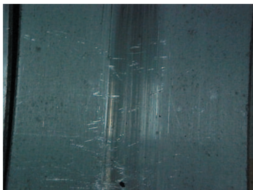
Fig. 8.2.8 Cojinetes de biela contaminados y con rayas circunferenciales en la dirección del hueco de lubricación
