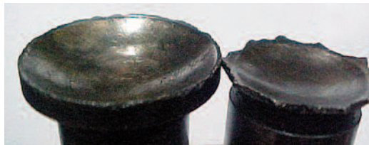
Fig. 12.4.4 – Detalle de desgaste y de rotura de la base
