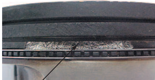
Fig. 2.15.1 Pared entre ranuras quebrada en pistón aplicado en motores línea Liviana
