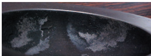
Fig. 2.6.2 Pulverización ocurrida parcialmente fuera de la cámara de combustión
